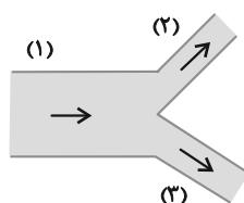
شارش آب در لوله (۳) چند لیتر بر دقیقه است؟ ( $D_2 = 2D_3$  و D قطر لوله است).
