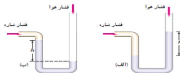
(۱) در شکل الف فشار هوا از فشار شاره بیشتر است
