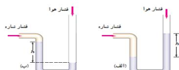
(۲) در شکل الف فشار هوا از فشار شاره کمتر است
