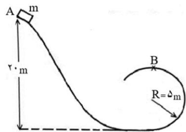
جسم کوچکی از نقطه **A** روی سطح بدون اصطکاکی رها شده و پس از پیمودن سطح شیبدار و نیمی از مسیر دایره‌ای (مطابق شکل) از نقطه **B** عبور می‌کند. تندی این جسم در نقطه **B** چند متربرثانیه است؟
