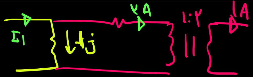
۴۴- در ترانسفورماتور سه سیم‌پیچ زیر، ۳۰۰ ولت مؤثر با فرکانس نامی به سیم‌پیچ ۱ اعمال می‌شود. اگر از مقاومت مغناطیسی هسته ترانسفورماتور و پراکندگی شار اطراف سیم‌پیچی‌ها صرف‌نظر شود، جریان  $I_1$  چند آمپر است؟
