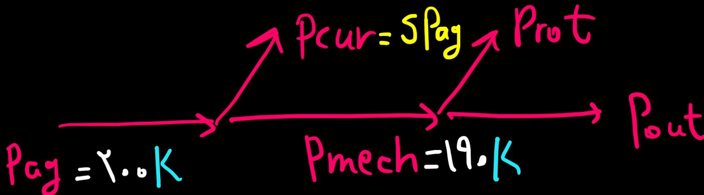
۳۹- یک موتور القایی قفسه‌ای سه‌فاز ۶ قطب ۴۴۰ V و فرکانس ۵۰ Hz در حال کار با لغزش ۵٪ است. تفاضل سرعت
