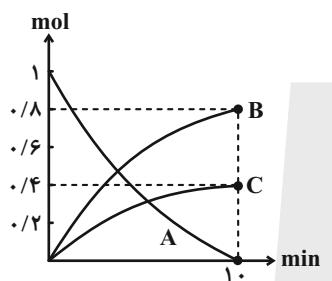
$$\bar{R}_{\text{واکنش}} = 2 \times 10^{-2} \text{ mol.L}^{-1}.min^{-1} \quad (1)$$
