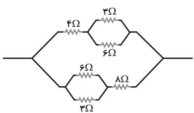
$$\begin{aligned} R' &= 4 + \frac{3 \times 6}{3+6} = 6\Omega && \text{شاخه بالا} \\ R'' &= \frac{6 \times 3}{6+3} + 8 = 10\Omega && \text{شاخه پایین} \end{aligned}$$
