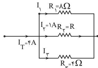
$$\frac{I_3}{I_1} = \frac{R_1}{R_3} \xrightarrow{I_1=x} \frac{I_3}{x} = \frac{8}{4} \rightarrow I_3 = 2x$$
