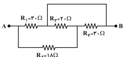
۵۵- با توجه به شکل زیر، مقاومت معادل بین دو نقطه A و B برابر چند اهم است؟
