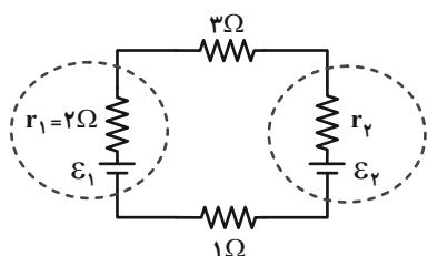
۵۳- شکل زیر قسمتی از یک مدار الکتریکی است. اگر  $V_A - V_C = 2\text{V}$  باشد، توان خروجی باتری چند وات است؟
